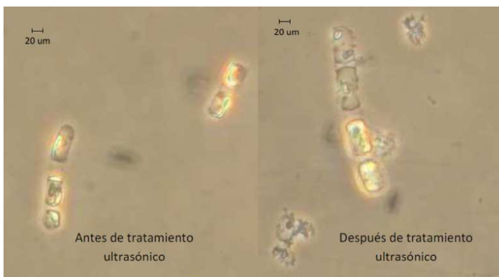
Figura 39. Skeletonema costatum sometida a dosis ultrasónica de 23 Khz de frecuencia, 34.291 W/m 2 de intensidad y 10 segundos de exposición.
