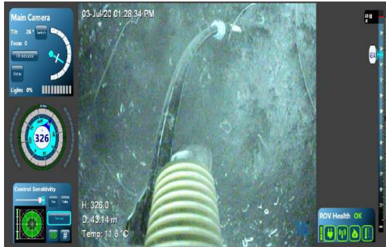
OBJETO: Trozo de tubo HDP (oxígeno) PROFUNDIDAD: 43m AREA: Bajo central de lateral Sur de posición de modulo
