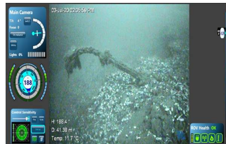
OBJETO: restos de cabo fondeo PROFUNDIDAD: 41m AREA: Bajo central de lateral Sur de posición de modulo
