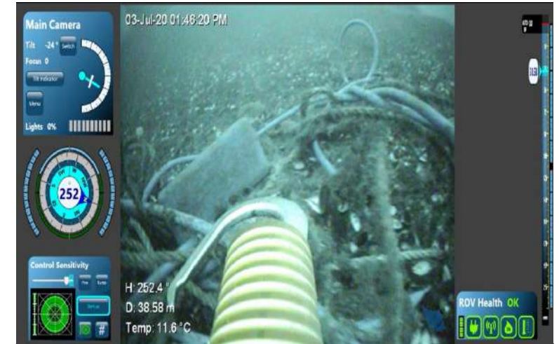
OBJETO: 2 restos de cabo, 1 manguera Lif UP, 1 potala de 40kg PROFUNDIDAD: 39m AREA: Bajo central de lateral Sur de posición de modulo
