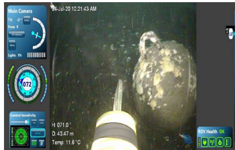
OBJETO: Contrapeso de 40kg PROFUNDIDAD: 43m AREA: Bajo central de posición de modulo
