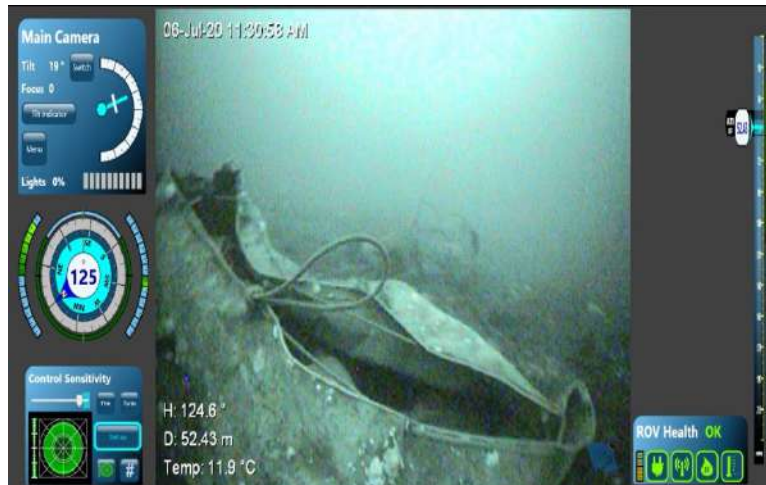
OBJETO: Lona cubre compresor PROFUNDIDAD: 52m AREA: Bajo de posición de modulo
