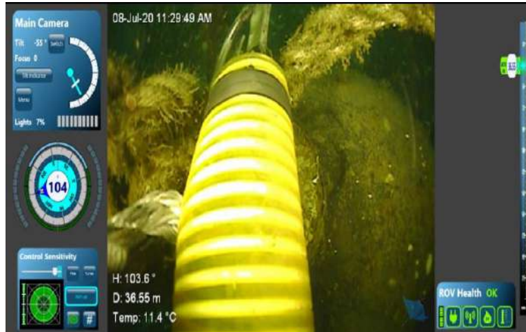
OBJETO: Contrapeso 90kg PROFUNDIDAD: 37m AREA: Bajo de posición de modulo
