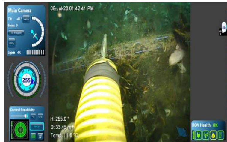
OBJETO: Manguera o plansa 10m PROFUNDIDAD: 33m AREA: Bajo central de posición de modulo
