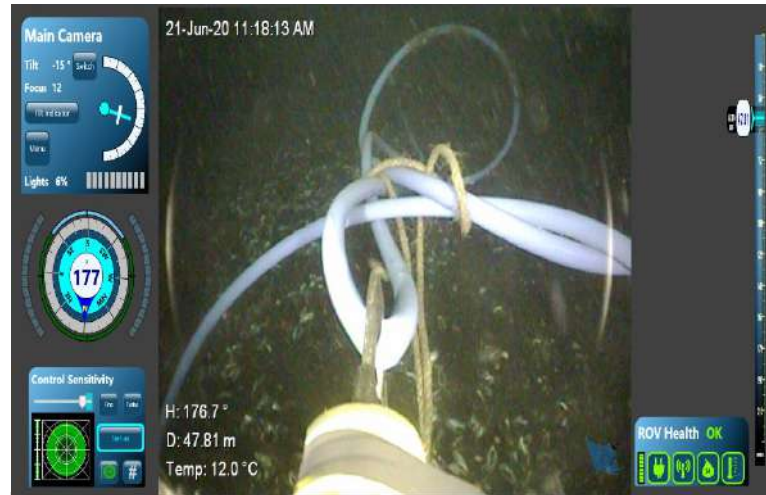
OBJETO: Manguera de aire de Lif-UP PROFUNDIDAD: 47m AREA: Bajo cabecera SE de posición de modulo
