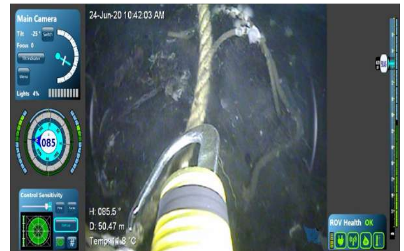
OBJETO: Restos de cabos (2 chicotes). PROFUNDIDAD: 51 m AREA: Bajo central de lateral Sur de posición de modulo
