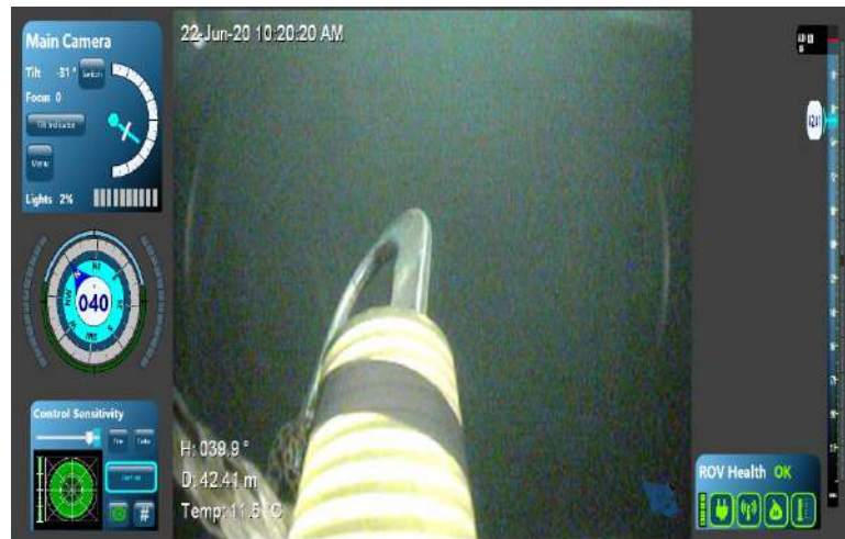
OBJETO: Tramo corto de malla pecera PROFUNDIDAD: 43 m AREA: Bajo Esquina SE de posición de modulo
