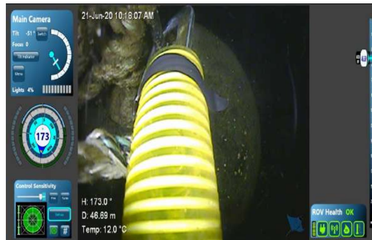
OBJETO: Contrapeso de 90 Kg PROFUNDIDAD: 47m AREA: cabecera SE de posición de modulo
